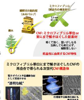
結晶性を操作し、セルロース結晶の特性を 高度発現させる技術基盤の創発に取り組む
