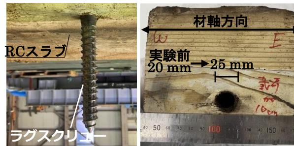
写真2(左) 加熱終了後のラグスクリューの変形状況
