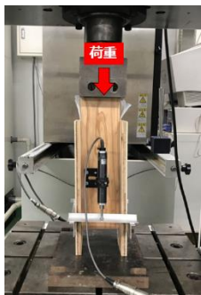
図1 釘接合部のせん断試験
